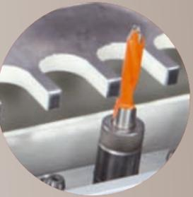
Bits replaced quickly and easily! The machine has 21 quick-change chucks. Les forets se remplacent facilement et en un instant! La machine est en effet équipée de 21 mandrins conçus pour raccord rapide.
