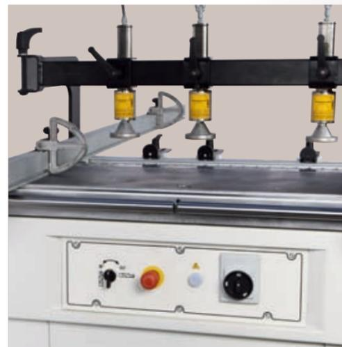
All controls are ergonomically positioned on the front of the machine. This includes the switch which sets the boring head at a 45° angle, allowing for an immediate changeover between operations. Toutes les commandes, comme l'interrupteur pour incliner de 45° la tête de perçage qui rend immédiat le passage d'une phase à l'autre, sont placées sur le devant de la machine, de manière ergonomique.
